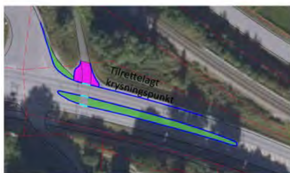
Figur 31 Alt. 1C: Utbedring av tilrettelagt krysningspunkt
